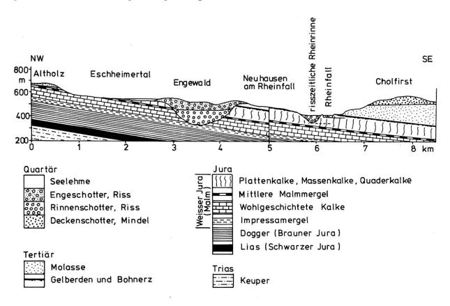
Fig. 3 Geologisches Querprofil durch das Rheinfallgebiet vom Randen zum Cholfirst. In der Umgebung des Rheinfalls treten von der Juraformation nur die höchsten Kalksteinlagen zutage. Das Profil zeigt, welche Schichten in der Tiefe zu erwarten sind. Eine am Rheinfall angesetzte Tiefbohrung würde unter den Jura- und Triasschichten in etwa 700 m Tiefe auf das sogenannte Grundgebirge stossen, wie es im Schwarzwald zum Vorschein kommt (vermutlich Gneis oder Granit).
