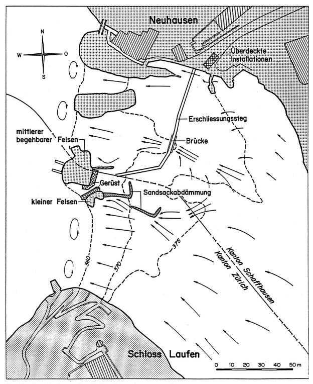
Fig. 10 Installationen für die Erosionsschutzmassnahmen.
