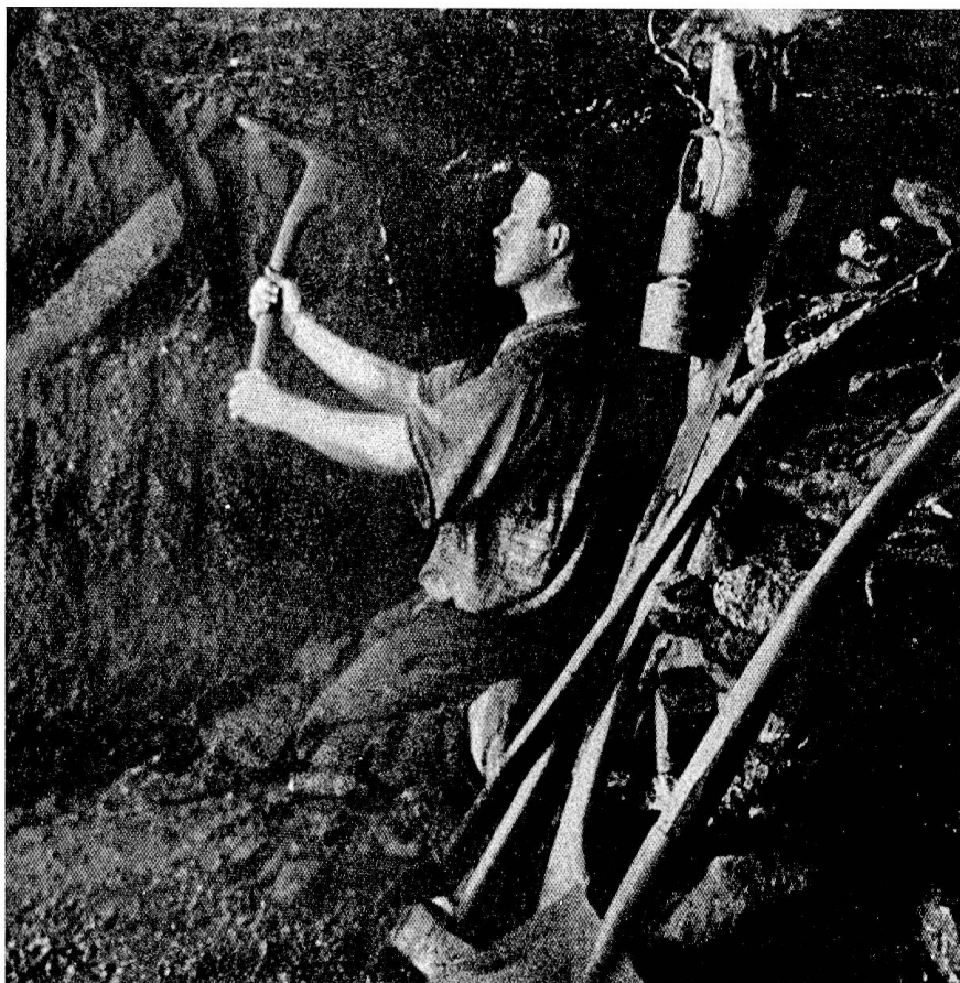
Abb. 31 Bohnerzabbau im Stollen (Pickel Abb. 14)
