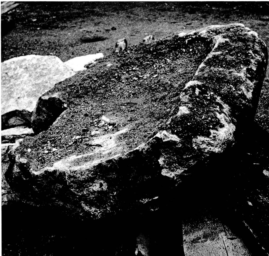
Abb. 27 Bodenrein aus dem Hochofen am Laufen
