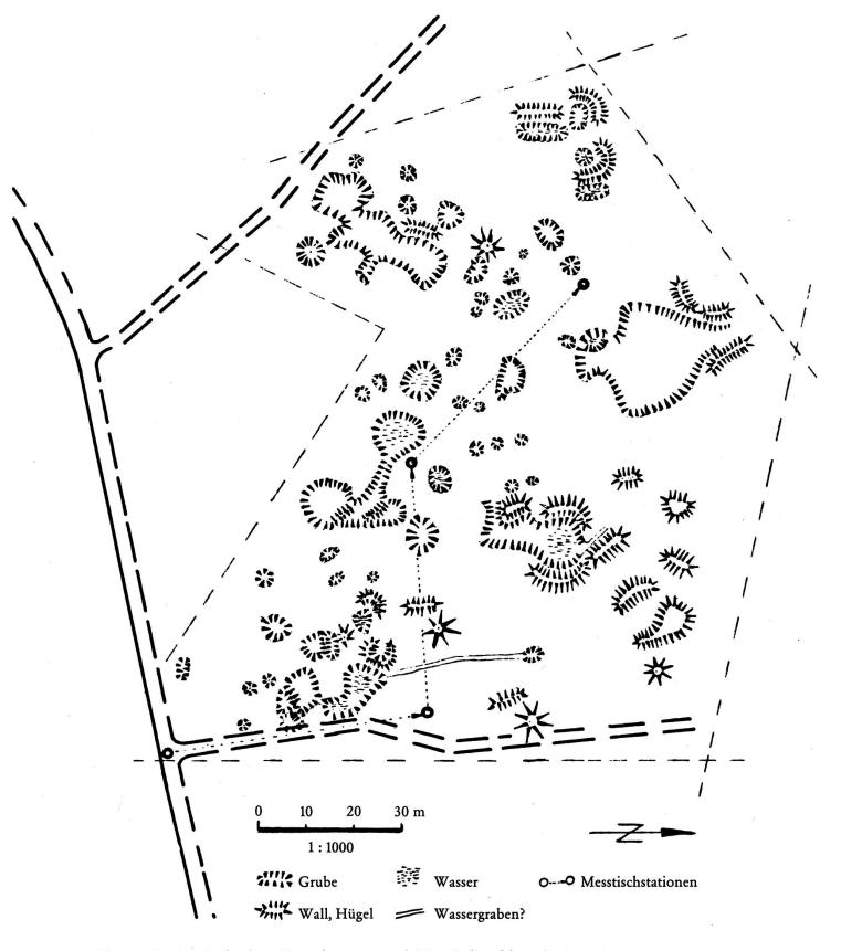
Fig. 9 Heutige Grubenlage, Versuchsmessung mit Messtischverfahren (6. 4. 1982).
