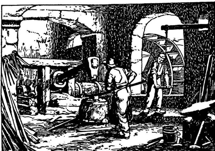
Fig. 20 Modell einer Eisenschmiede mit einem Schwanzhammer, 1. Hälfte 19. Jahrhundert (siehe auch Abb. 29/30).
