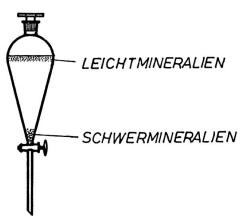
Abb. I Scheidetrichter nach Squibb zur Trennung der Leicht- von den Schwermineralien in Bromoform.
