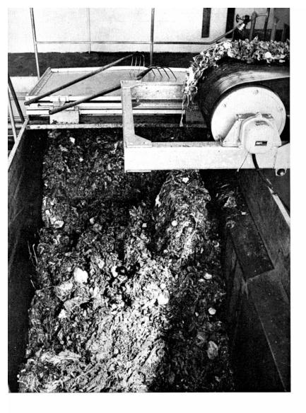
Rechengut, das mit einer automatischen Rechenreinigungsmaschine entfernt wurde und nun in eine Transportmulde gebracht wird.
