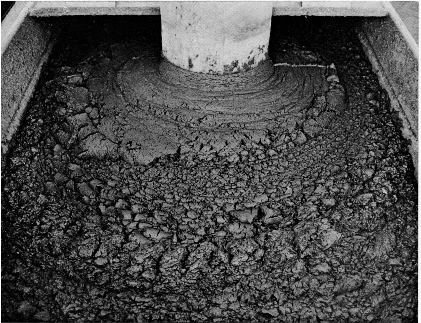
Entwässerter, stichfester Klärschlamm, welcher gemeinsam mit Hauskebricht zu Kompost verarbeitet wird.
