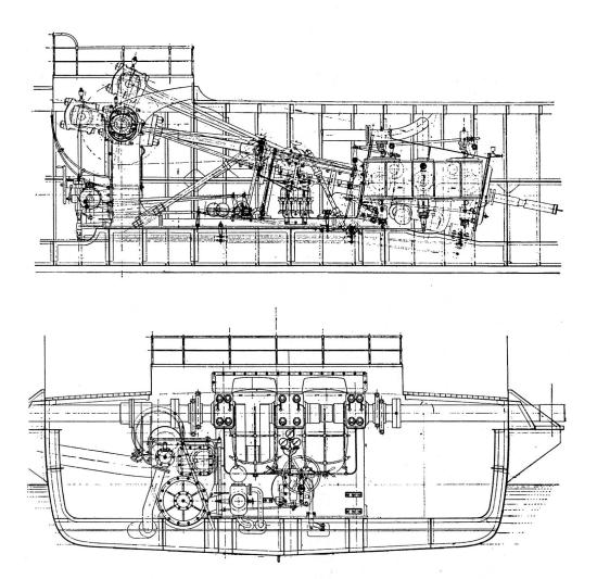
Fig. 17 Maschine der Schaffhausen. Aufriss, von Backbord gesehen, und Frontansicht (Zeichnung Gebrüder Sulzer, Winterthur, aus der technischen Literatur).
