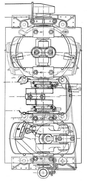
Fig. 10 Schiffsmaschine mit oszillierenden Zylindern. Grundriss, ohne den Kondensator (aus Zeitschrift «Engineering» 1886).
