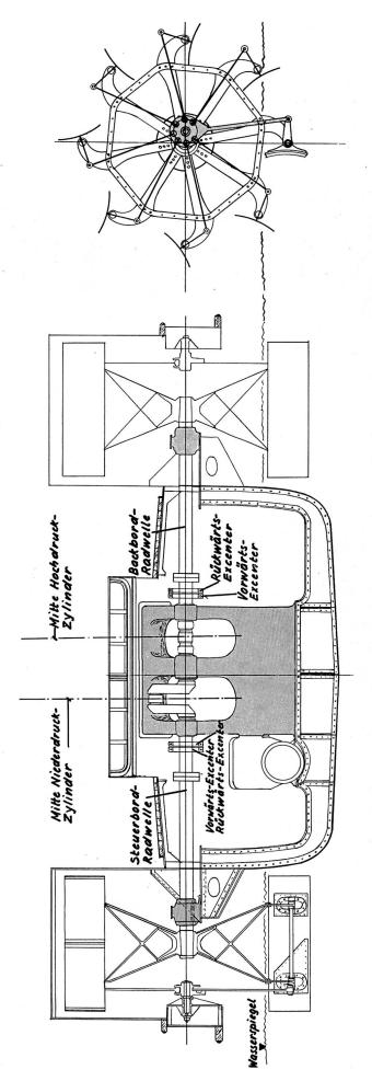
Fig. 23 Schaufelräder des Dampfschiffes Schaffbausen. Querschnitt und Aufriss (Zeichnung H. Bendel, Schaffhausen).
