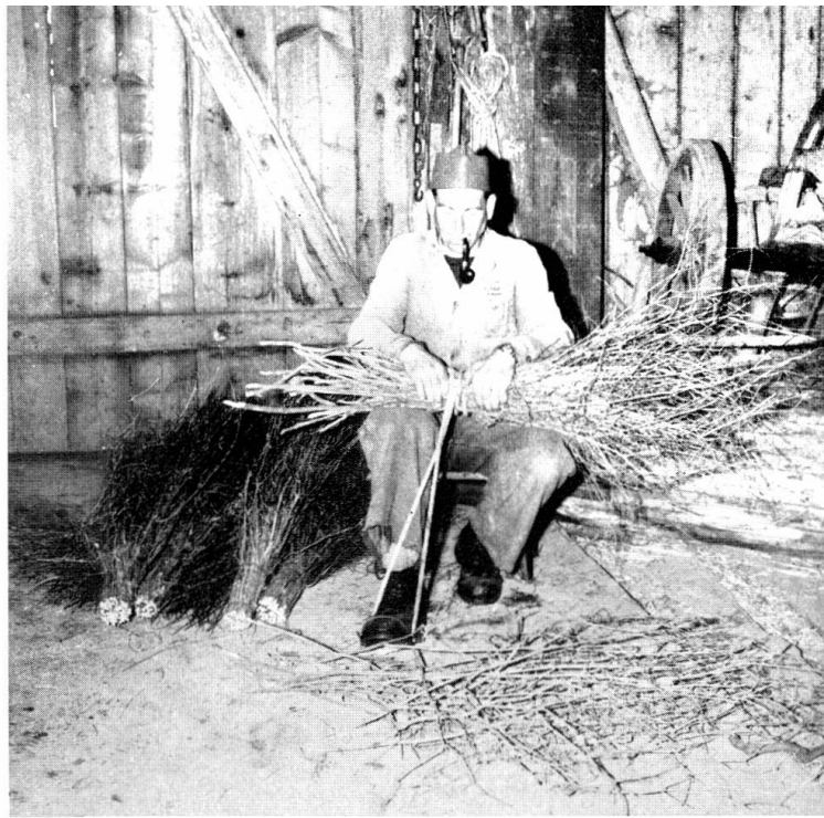
120./121. Sibingen 1963. Beim Besenmachen. Der Bauer holt sich im Herbst sein «Beseriis» ( Lonicera Xylosteum ) im Wald. Im Winter, wenn die Reiser trocken sind, bindet er die Besen. Mit einem Strick zieht er sie fest zusammen und bindet sie mit Draht oder gespaltenen Hulftern (Wolliger Schneeball).
