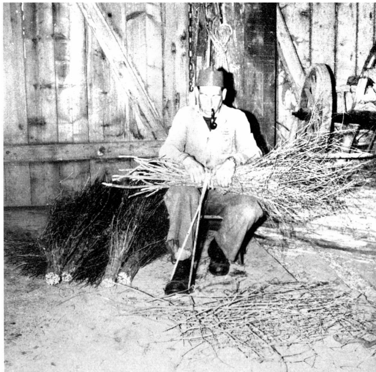
120./121. Siblingen 1963. Beim Besenmachen. Der Bauer holt sich im Herbst sein «Beseriis» ( Lonicera Xylosteum ) im Wald. Im Winter, wenn die Reiser trocken sind, bindet er die Besen. Mit einem Strick zieht er sie fest zusammen und bindet sie mit Draht oder gespaltenen Hulftern (Wolliger Schneeball).
