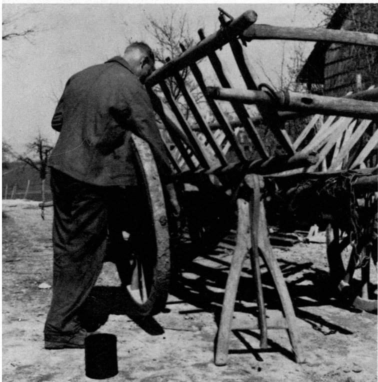
134. Siblingen 1963. Der Schmierbock unter dem hintern Achsenstock hält den Wagen auf einer Seite hoch. Der Fuhrmann kann das Rad herausziehen und die Achse schmieren.
