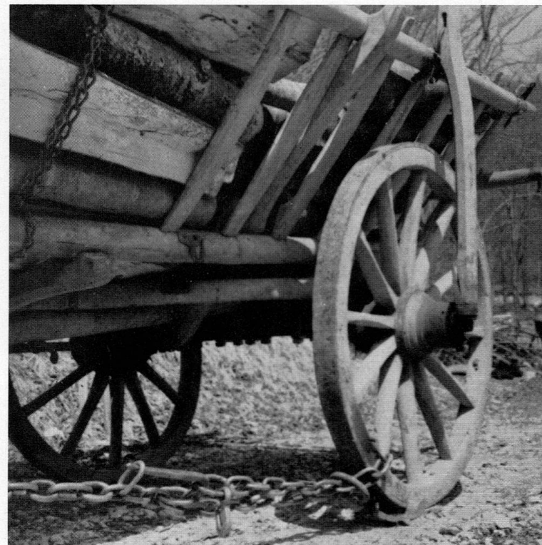
135. Siblingen 1963. Die schwere Spannkette befestigt man hinter dem vordern Achsenstock am Langbaum. Das gespannte Rad sitzt auf einem Radschuh fest. Er verhindert eine Abnützung des Radreifens an dieser Stelle.
