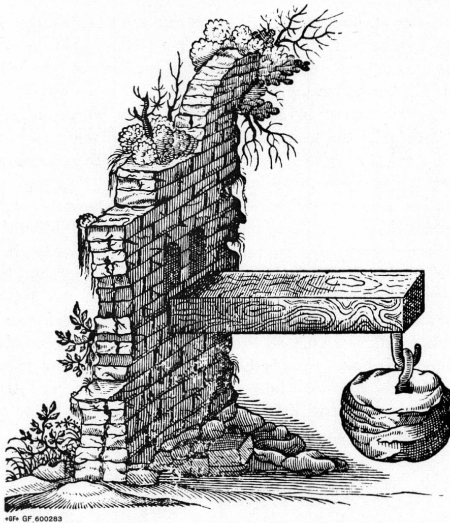
Abb. 8. Versuch über die Biegefestigkeit (Gesetz unabhängig vom Werkstoff), aus Galilei «Discorsi e Dimostrazioni Matematiche» Leiden, 1636
