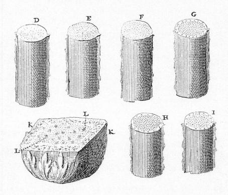
Abb. 7. Mikrostrukturbilder von Tempergussproben, aufgenommen von R. A. F. de Réaumur. Die Proben D, E, F, G, L, H und I zeigen eine Strukturbilderreihe in Abhängigkeit von der Zeit des Temperns. Aus: R. A. F. de Réaumur. L'art de convertir le fer forgé en acier et l'art d'adoucir le fer fondu. Paris, 1722
