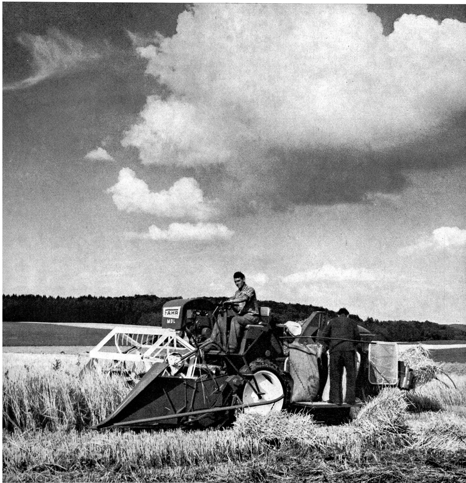
55. Bei Gennersbrunn, 1957. Wie ein Ungetüm fährt der Mähdrescher durch die Getreidefelder, mäht, drischt, lässt die Körner in Säcke fließen und wirft das Stroh hinten gepresst und gebunden auf die Seite.
