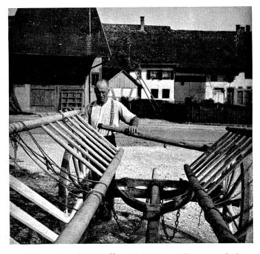
21. Einsetzen der Welle. Die Leitern liegen auf dem Achsenstock, die Grättelarme auf dem Langbaum («Landwid») auf. Mit der Kette bindet man die Leiterbäume fest.
