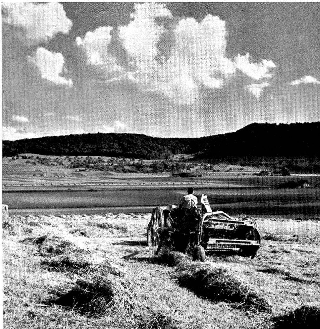
33. Bei Löhningen, 1958. Mähdeln mit dem Schwaden- rechen, der einen verstellba- ren Tambour besitzt. Die quer zur Fahrtrichtung ge- stellte Trommel kehrt das Heugras.
