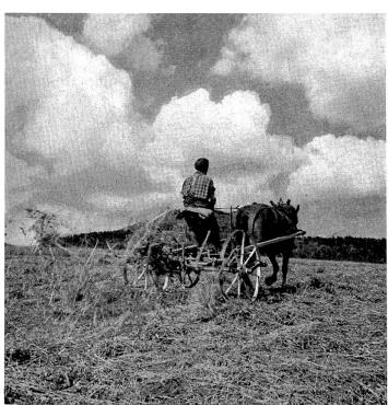
29. Bei Löhningen, 1958. In den letzten Jahren fand diese Art Maschinen bei uns Eingang. Bei Drehung der Räder im Sinne des Uhrzeigers wird das Heugras gewendet, im umgekehrten Sinne gemähdelt.
