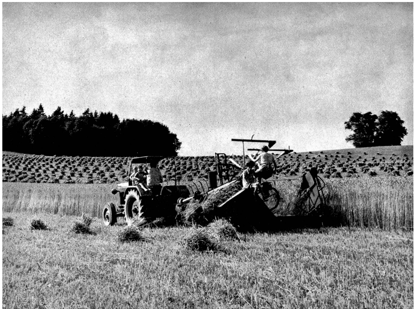
52. Bei Gennersbrunn, 1957. Der Bindemäher mäht und bindet das Getreide zu Gärbchen. Diese bei uns heute verbreitetste Erntemaschine ist den Getreidebauern schon seit drei Jahrzehnten ein guter Helfer.
