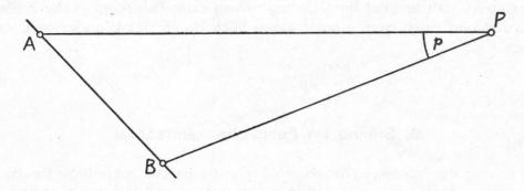
Fig. 5 Standlinienmethode für die Entfernungsbestimmung.
