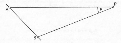
Fig. 5 Standlinienmethode für die Entfernungsbestimmung.
