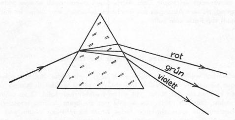
Fig. 3 Zerlegung des Lichtes in Spektralfarben durch ein Glasprisma. Das Prisma muß man sich aus der Papierfläche herausragend vorstellen.
