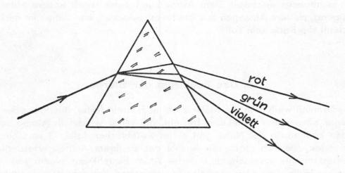
Fig. 3 Zerlegung des Lichtes in Spektralfarben durch ein Glasprisma. Das Prisma muß man sich aus der Papierfläche herausragend vorstellen.
