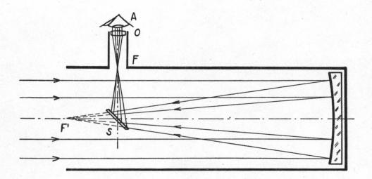
Fig. 2 Spiegelteleskop nach Newton.
