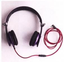
4: Kopfhörer; Eloise Frey. Mit Hilfe von zwei einfachen Schlauchbriden wurden die abgelösten Schichten des klappbaren Bügels kraftschlüssig miteinander verbunden. Die Lösung ist zwar pragmatisch, ermöglicht aber wieder die Arretierung der Grösse des Bügels.
