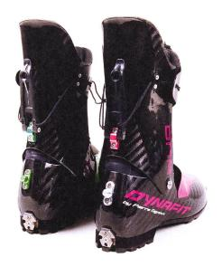
2: Verriegelungszapfen Dynafit DNA Skitourenschuh; Daniel Schuster. Damit der Skischuh bei der Abfahrt die Kraft vom Fahrer auf den Ski wieder übertragen kann, musste der gebrochene Verriegelungszapfen ersetzt werden. Der neue Zapfen ist aus Aluminium gefräst.
