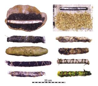
Abb. 6: «Einpacken» von Weicheisen-Barren zur «Aufkohlung» in einer Ummantelung mit kohlenstoffreicher Holzkohle (links oben) und anderen organischen Materialien (unten). Als Abdichtung dient eine Lehmumhüllung des Ganzen (Mitte links), die sorgfältig getrocknet werden muss, ohne Risse zu bekommen. © Foto Alex R. Furger
