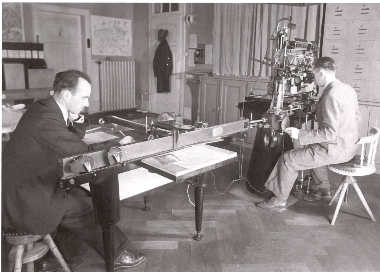
Ingenieure der Landestopografie bei der Arbeit am Stereografen Wild No. 3, 1938. © Swisstopo, Bildsammlung, Inv. 000-398-991
