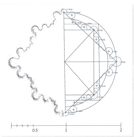
Abb. 5: Durch fachlich fundiertes Nachkonstruieren wird die unscharfe Punktwolke in eine präzise Darstellung der «Bauteillogik» überführt und damit selbst zum erweiterten Informationsträger.
