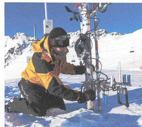
Abb. 3: Jeden Tag seit 84 Jahren führt das SLF auf dem Weissfluhjoch, Davos, Schneemessungen durch. Hier die moderne Messung einer Schneeverfrachtung.
