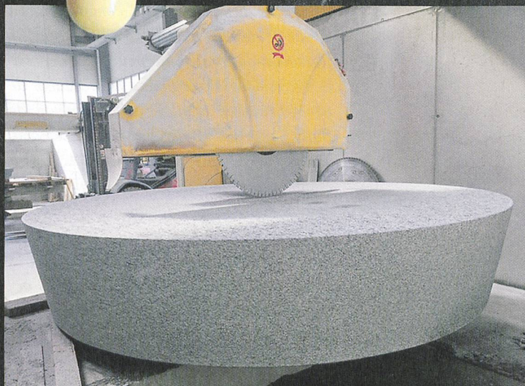
Lavorazione con una fresa a controllo numerico di una fontana circolare presso le cave di Cresciano, 2018: Fontana per il comune di Oberägeri, scultore Karl Imfeld.
