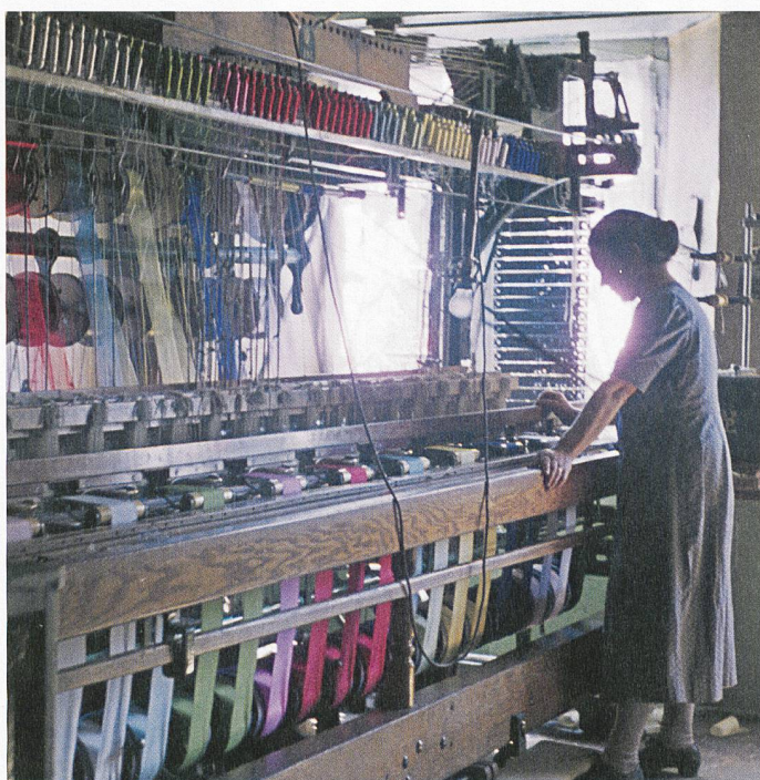
Eine Posamenterin aus Rünenberg bei ihrer täglichen Arbeit: Der mächtige, mit Elektromotor betriebene Bandwebstuhl dominiert die Stube (1943).
