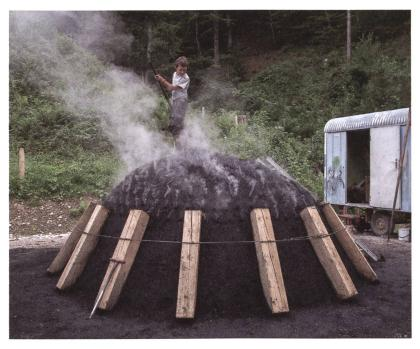
stehen, muss der Mantel ständig verdichtet werden. Dazu hängt sich der Köhler seitlich an eine Stange und tritt die schwarze «Löschi» mit seinen Füssen fest.
