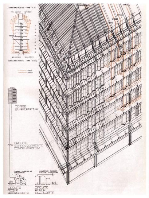
La distribution du dispositif d'air conditionné selon le système «dual-duct» depuis la centrale de production du dernier niveau du grand magasin. Les conduits s'arrêtent au fur et à mesure des étages qu'ils desservent; le mouvement de la façade exprime ainsi de manière très fidèle le fonctionnement intrinsèque du réseau.
