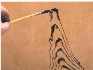
Alternativ kann der Holzkern auch aufgemalt werden. Mit dem Malpinsel wird mit dunklerer Ölfarbe die Maserstruktur vorgelegt und diese anschliessend mehrfach überabeitet und verfeinert.
