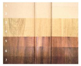
Mehrschichtiger Aufbau mit 2 Grundanstrichen (1/2); erstem Lasurauftrag und Holzmaser mit Bierlasur (3); auftragen der Poren mit Porenwalze (4); erster Öllasurauftrag sowie einarbeiten und verwischen von Maser und Wimmern (5); zweiter Öllasurauftrag zur farblichen Angleichung z.B. an den Boden (7).
