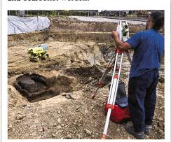
Arbeiten unter Zeitdruck. Tachymetrische Aufnahme eines frühmittelalterlichen Töpferofens in Oberwil BL, 2013. Die Messungen werden direkt im CAD-System des Notebooks angezeigt.
