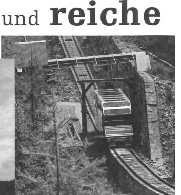
Standseilbahn Le Châtelard - Les Montuires, Le Châtelard (VS), von Von Roll (1919). Wagen in Wannenabschnitt mit Seil-Niederhalte-Joch und vorgelagertem Ballastwagen.
