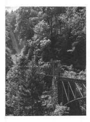
Die Giessbachbahn am Brienzersee wurde – als eine der ersten Standseilbahnen überhaupt – 1879 in Betrieb genommen. Der ursprüngliche Wasserübergewichtsantrieb wurde 1912 durch eine Zwillingsturbine in der Bergstation ersetzt. Erst 1948 wurde die Bahn elektrifiziert und halbautomatisiert.
