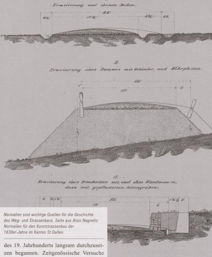
des 19. Jahrhunderts langsam durchzusetzen begannen. Zeitgenössische Versuche ergaben, dass ein allein mit Handrammen und durch den Verkehr verdichteter Strassenkörper 35 bis 45 Prozent Steinmaterial enthielt, ein gewalzter Steinbahnkörper jedoch 70 bis 80 Prozent.
