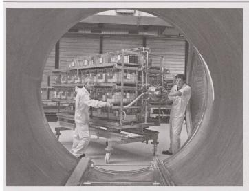
Die Gitterkörbe mit den Dokumenten werden in die Behandlungskammer eingefahren.
