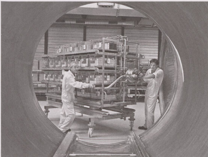
Die Gitterkörbe mit den Dokumenten werden in die Behandlungskammer eingefahren.
