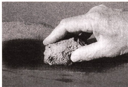
Schleifen von Mahagoniholz mit Formbimsstein und Leinölfirnis.
