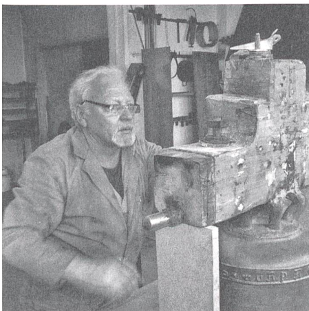
Injektionen und Ausgiessen der Schwachstellen im Obstholzjoch.
