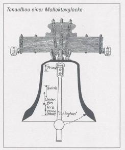
Der Durchmesser entspricht ungefähr dem Vierzehnfachen der Schlagringstärke. Der Durchmesser verhält sich zur schrägen Höhe ungefähr im Verhältnis 14:11. Eine Moll-Oktavglocke mit einem Durchmesser von ca. 140 Zentimeter wird demnach über eine schräge Höhe von ca. 110 Zentimeter verfügen. Die Gesamthöhe einer Moll-Oktavglocke entspricht in der Regel knapp dem Mass des Durchmessers.
