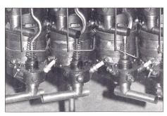
Der Dufaux-Flugmotor wurde am Pariser «Salon de l'Automobile» von 1907 ausgestellt und erregte mit seiner Leistung von 120 PS bei nur 85 kg Konstruktionsgewicht grosses Aufsehen.
