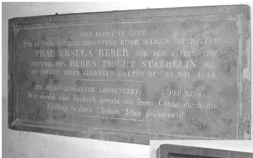
Ein verwitterter, mit grauem Schleier bedeckter Epitaph aus schwarzem Alpenkalk links vor und rechts nach einer Behandlung mit Leinöl.
