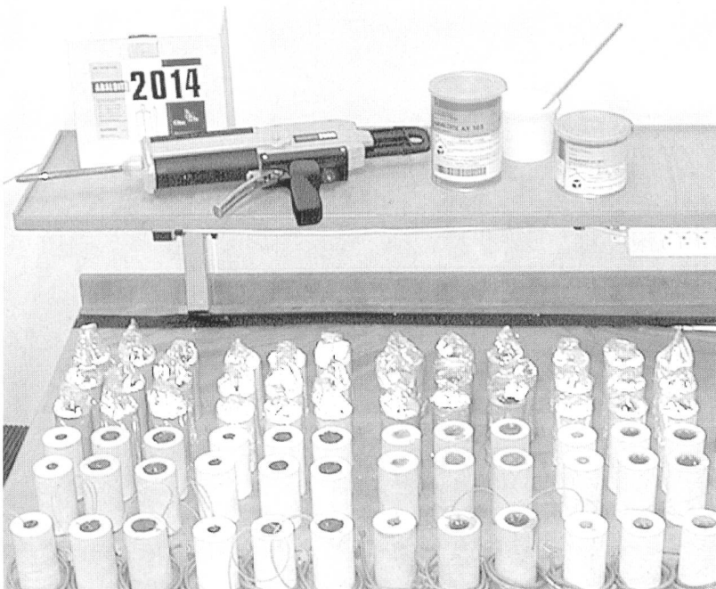
Expoxyd-Naturstein. Probenkörper mit Thermoelementen
