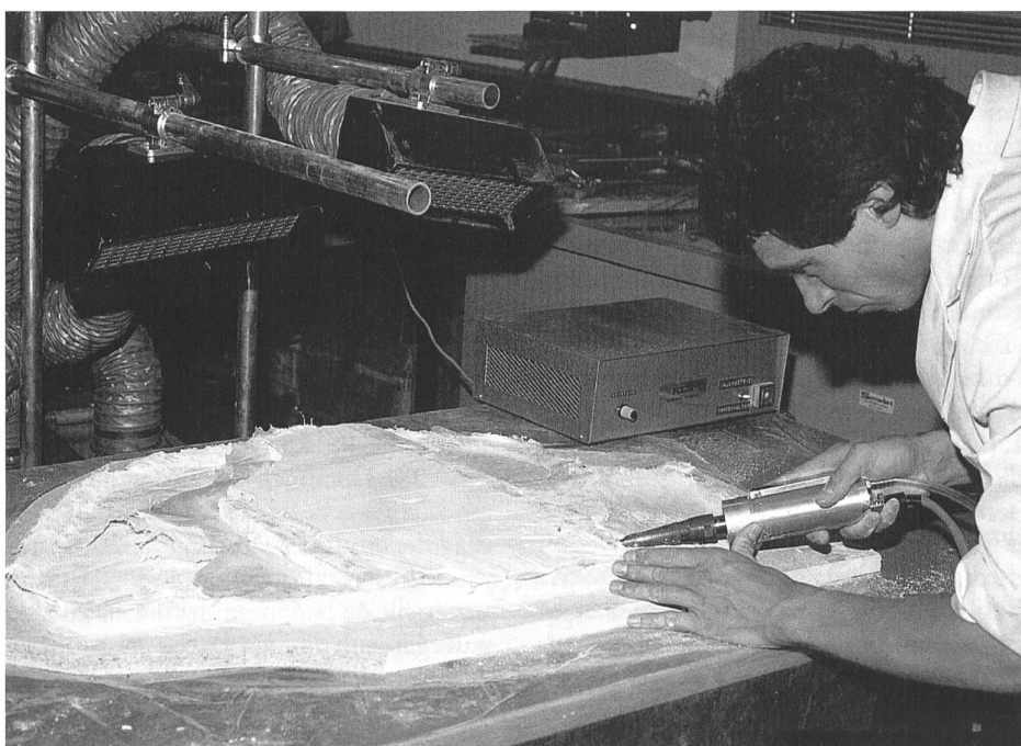
Rückseitiges Reinigen eines Freskenfragmentes mit einem Ultraschallmeissel (Foto: Archäologisches Institut Universität Zürich)
