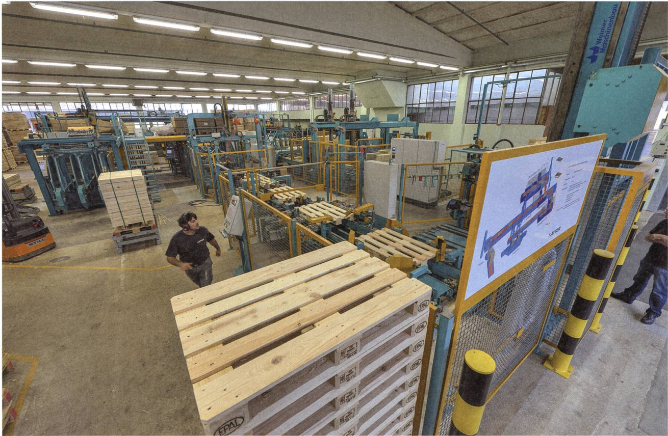
Automatisierte Produktion von Paletten bei der Holzbau Kayser AG in Oberdorf.
