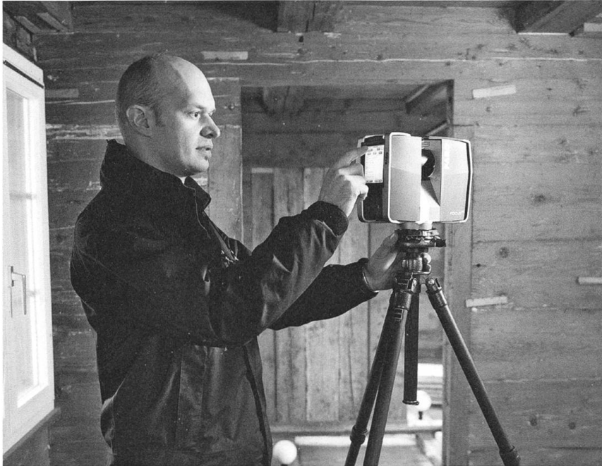
5.1. Lasertechnik für das Vermessen von Räumen und Häusern.
