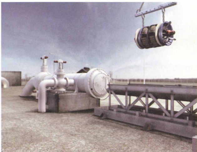
Einsatzbereiter Molch wird zur Schleuse transportiert.
