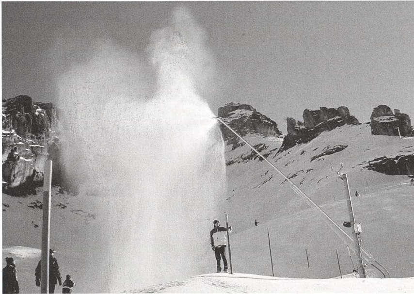
19.2. Die neue entwickelte Schneelanze, hier im Testeinsatz auf dem Titlis, soll bis zu 80 Prozent weniger Energie verbrauchen.
