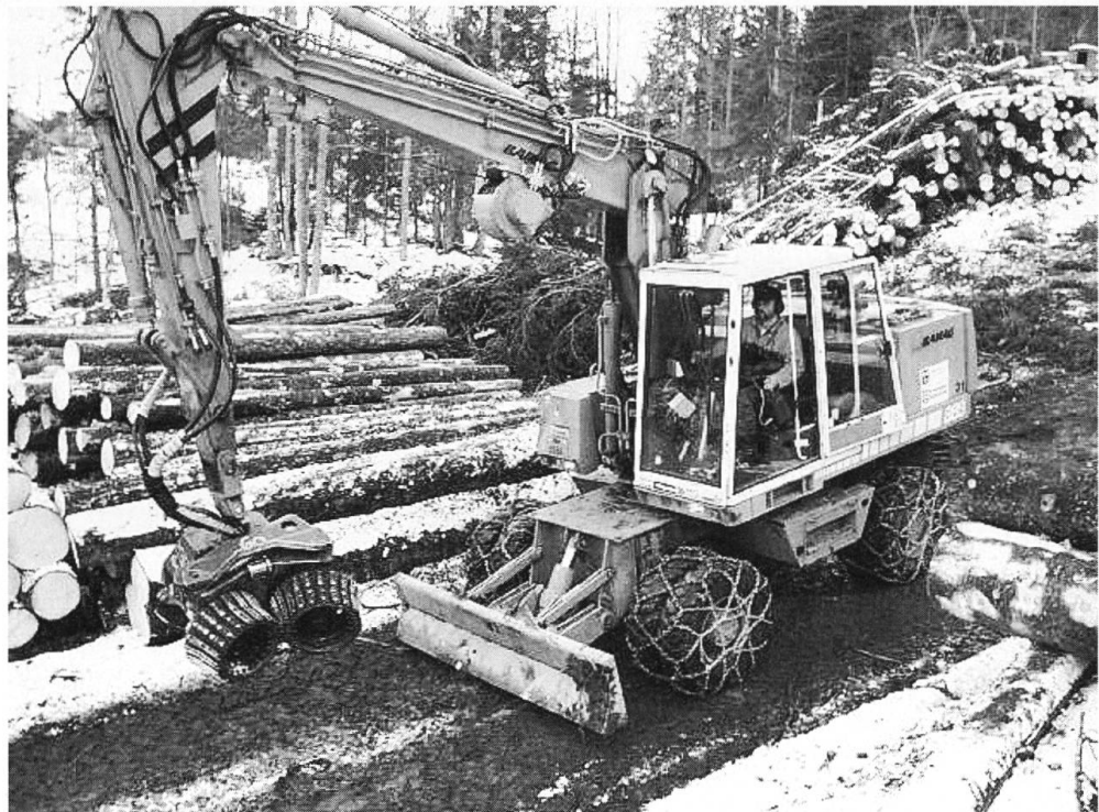
Maschinen erleichtern die schwere Waldarbeit: «Woody 60» der Korporation Beckenried/Emmetten – Pneubagger mit Prozessor-kopf zum Entasten und Ablängen der Stämme.
