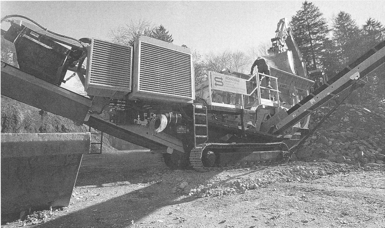
**3. Schleiss Recycling Bau AG.** Die im Bürer Hofwald stationierte Schrebag nahm eine neue Kompakt-Recyclingbrechanlage der Firma Gipo AG, Seedorf, in Betrieb. Mit dem Einsatz dieser Anlage schuf die eigenständige, seit 1991 bestehende Firma als erste in Nidwalden die Grundlage für eine zukünftige rationelle und umweltschonende Aufbereitung und Wiederverwertung von Ausbruch- und Abbruchmaterial.
