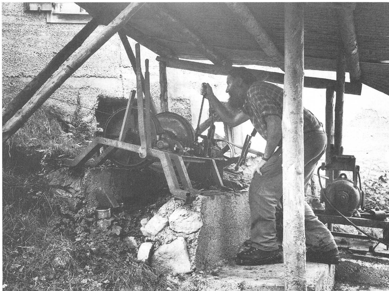
Das dritte und oberste «Grunggis-Seil», das von Hütti noch weiter hinaufführt. Selten sieht man Motor, Transportrad und Bremse so übersichtlich wie hier.
