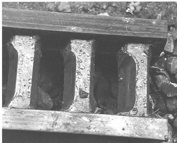
Ein Zahnstangensegment mit deutlich sichtbaren Abnützungerscheinungen
