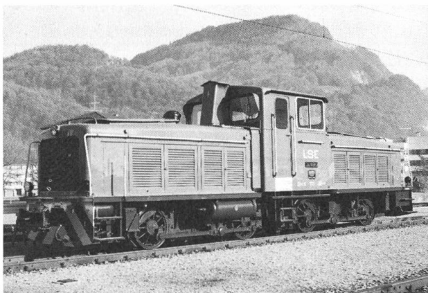
Diesellokomotive Gm 4/4 für schweren Rangier- und Überfuhrdienst. Sie konnte im Jahre 1973 in Finnland günstig erworben werden.
