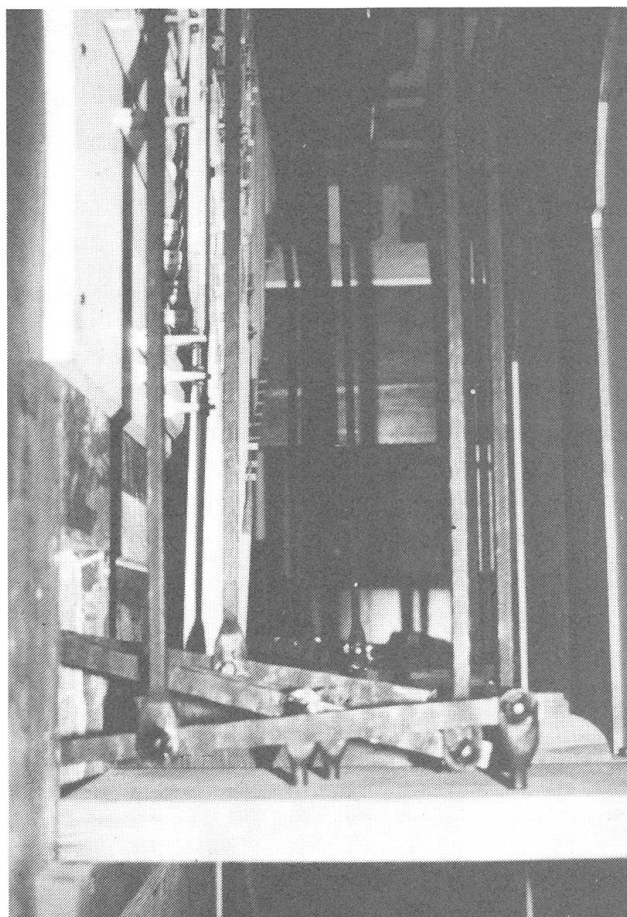
Blick ins Innere der Orgel mit der wiederhergestellten, schmiedeisernen Registratur.
