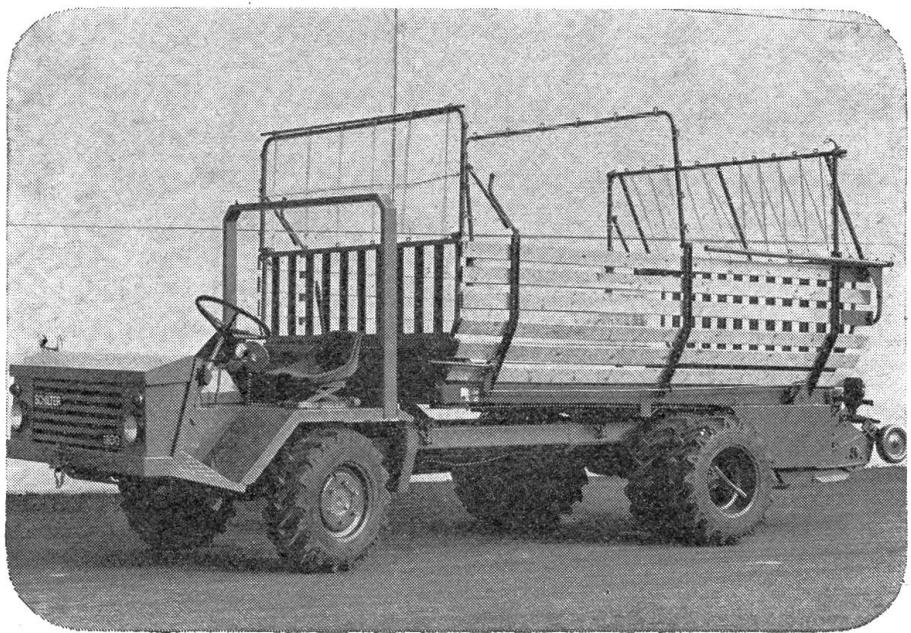
Er ist überlastsicher. Beweglich wie kein zweiter. Nichts bringt ihn aus dem Gleichgewicht. Das alles verdankt er dem Zwillingschassis, einer patentierten SCHILTER Spezialkonstruktion.
