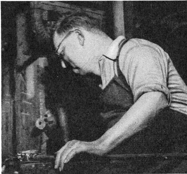
An der Wiege des Kaffeeglasses: Ein charaktervoller Glasbläser rollt die Kelchform aus, und in der nächsten Sekunde wird der Hals aufgesteckt werden
